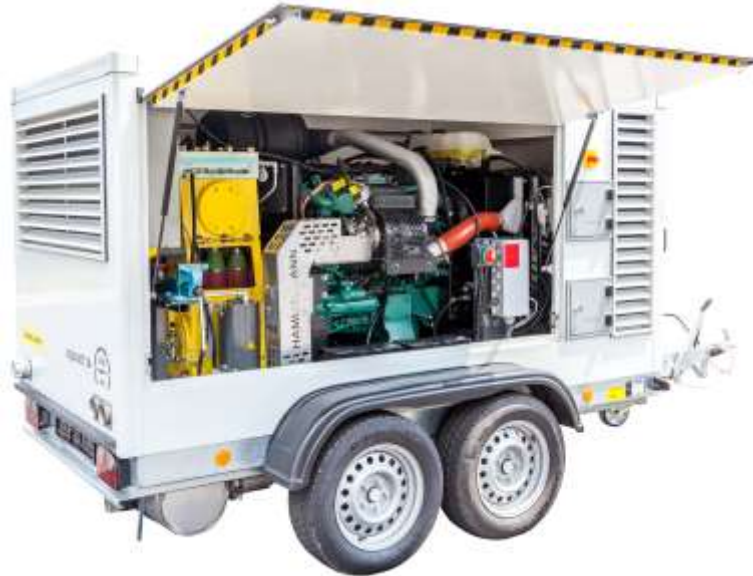
AUTONOME INSTALLATIE IN GELUIDGEDEMPTE AANHANGER
