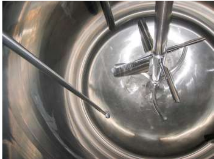
TÊTE DE NETTOYAGE AVEC LANCE DANS RÉACTEUR
